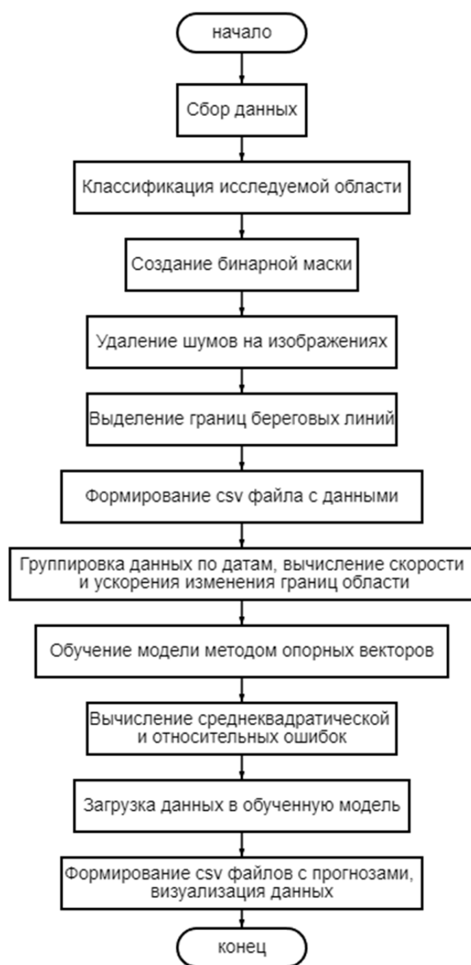
Рис. 7. Блок-схема работы интеллектуальной системы
